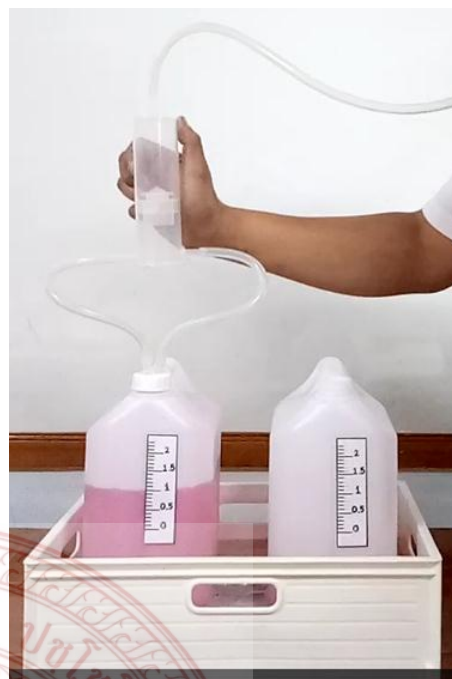
ภาพที่ ๓.๒๒ การทดลอง Incentive Spirometer NK๑ที่เจาะรูขนาด ๔ มิลลิเมตร
