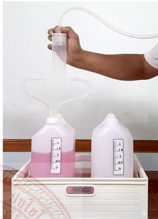
ภาพที่ ๓.๒๐ การทดลอง Incentive Spirometer NK๑ ที่เจาะรูขนาด ๒ มิลลิเมตร
