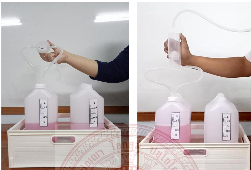
ภาพที่ ๓.๒๔ การทดลอง Incentive Spirometer NK๑ ที่เจาะรูขนาด ๖ มิลลิเมตร
