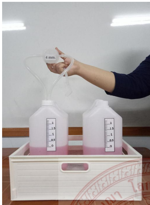
ภาพที่ ๓.๒๒ การทดลอง Incentive Spirometer NK๑ที่เจาะรูขนาด ๔ มิลลิเมตร
