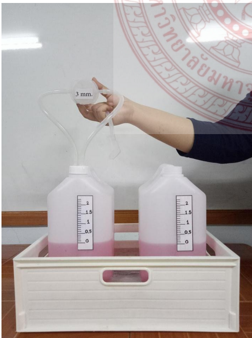
ภาพที่ ๓.๒๑ การทดลอง Incentive Spirometer NK๑ ที่เจาะรูขนาด ๓ มิลลิเมตร
