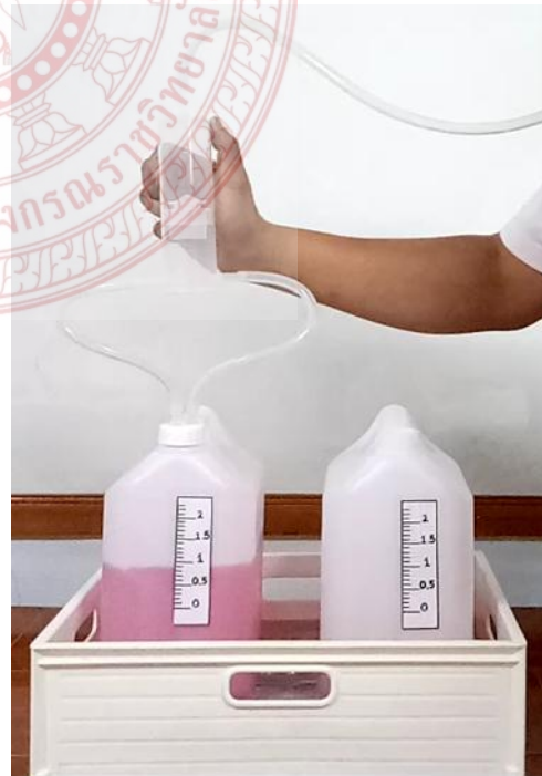
ภาพที่ ๓.๒๑ การทดลอง Incentive Spirometer NK๑ ที่เจาะรูขนาด ๓ มิลลิเมตร
