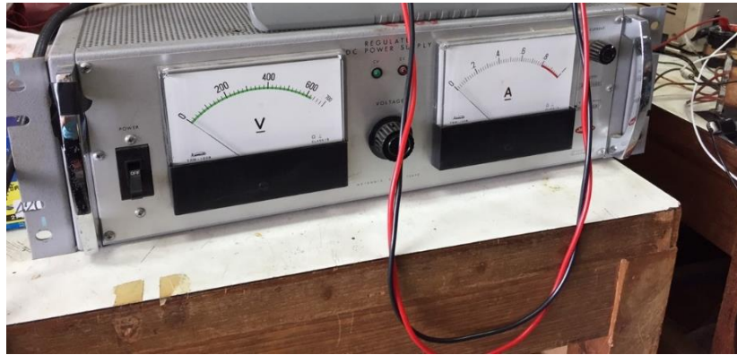
ภาพที่ 4.9 แสดงอุปกรณ์แหล่งจ่ายไฟเลี้ยงสำหรับวงจรในรูปที่ 4.7
