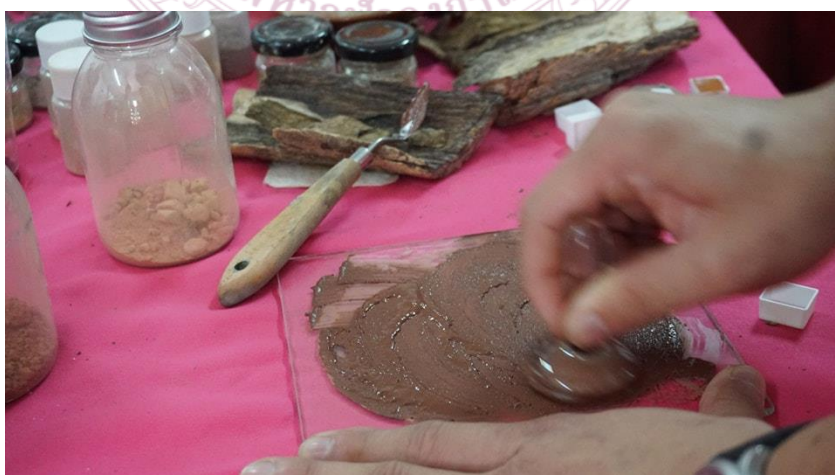
กระบวนการที่ ๕ นำผงที่กรองในกระบวนการที่ ๔ มาบดให้ละเอียดอีกครั้งจนผงสีเหนียวตัว
