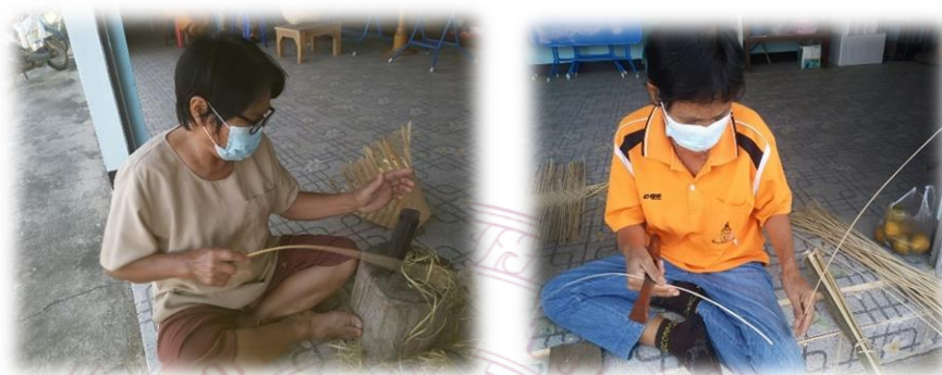
ภาพที่ ๔.๑๓ รูปการใช้เครื่องมือจักตอก หรือชุดเส้นไม้ไผ่ให้ได้ขนาดตามต้องการ
