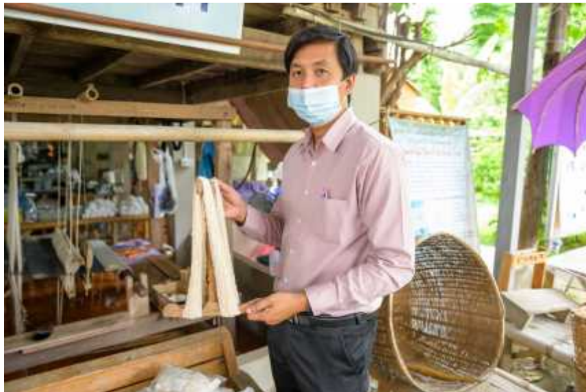
แผนภาพที่ ๔.๑๘ “เป่ หรือ เปี้ย” คือ อุปกรณ์ที่ใช้ในการม้วนฝ้ายออกจากอุปกรณ์ปั่นฝ้ายเป็นแท่งไม้ ปลายทั้งสองเป็นรูปตัวที่สลับด้านกัน
