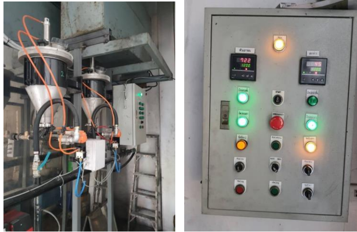
ภาพที่ 4.5 แสดงระบบการทำงานของเครื่องฟนสารวิมุตติและเตาเผาศพต้นแบบ เพื่อทดลองใช้สารวิมุตติในการฃาปนกิจ ที่มา : คณะผู้วิจัย 2564
