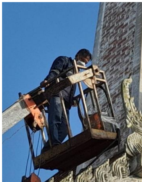
ภาพที่ 4.27 แสดงการเก็บตัวอย่างอากาศจากปล่องเมรุ วัดวัดพิรุณศาสตร์ ที่มา : คณะผู้วิจัย 2564
