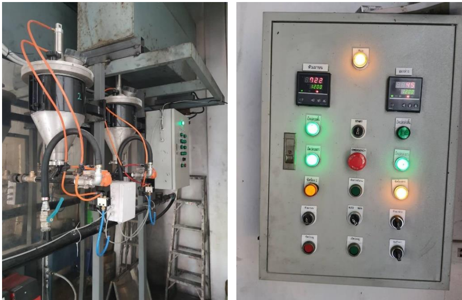
ภาพที่ 4.25 แสดงระบบการทำงานของเครื่องพ่นสารวิมุตติ และเตาเผาศพต้นแบบ เพื่อทดลองใช้สารวิมุตติในการฃาปนกิจ
