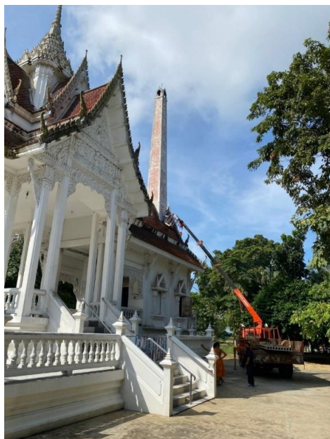
ภาพที่ 4.27 แสดงการเก็บตัวอย่างอากาศจากปล่องเมรุ วัดวัดพิรุณศาสตร์ ที่มา : คณะผู้วิจัย 2564
