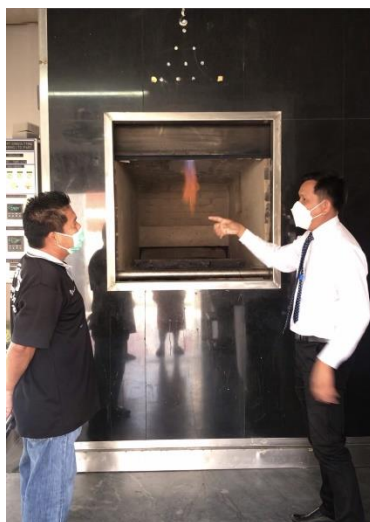
ภาพที่ 4.6 ระบบเตาเผา 2 ห้องเผา ระบบ LPG
